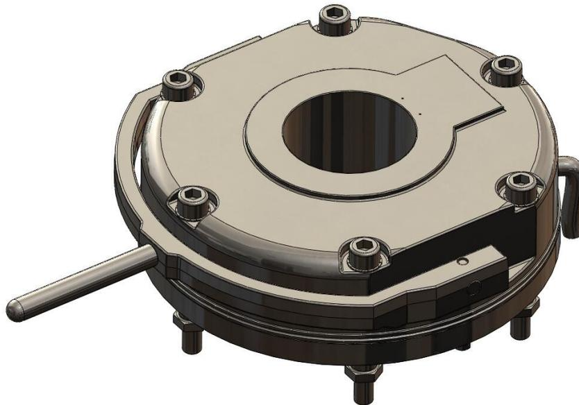
Nelle opzioni previste con la fornitura del freno esiste la possibilità di inserire un sistema di sgancio manuale. Questo può essere montato in sede, oppure dal Cliente. Si compone di un archetto in alluminio posizionato sul contenitore dell'elettromagnete e di due tiranti speciali con dadi autobloccanti ed una molla. Sul contenitore è realizzata la sede per il posizionamento dell'archetto in coincidenza dei fori per contenere i tiranti. Analoghi fori sono realizzati sull'ancora.
